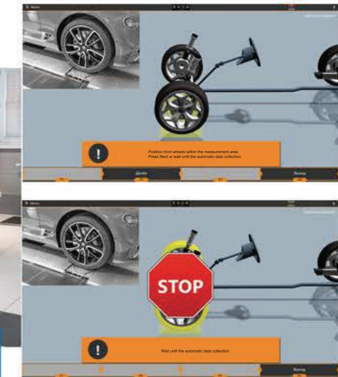
Brezkontaktni sistem strojnegavida z več video kamerami in sistemom projekcije pametne svetlobe za izvedbo 3D skeniranja vsakega kolesa v realnem času.
